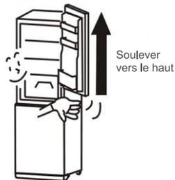
3. Démontez la charnière du milieu à l'aide d'un tournevis. Soulever la porte vers le haut pour la dégager de la charnière inférieure. Retirer la porte et déposer-la doucement sur une surface rembourrée.
