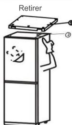
2. Soulever la porte vers le haut pour la dégager de la charnière du milieu. Retirer la porte et déposer-la doucement sur une surface rembourrée.
